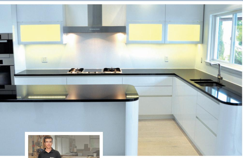
Mineralwerkstoff ist eine Mischung aus gemahlenden Mineralien und Pigmenten (ca. 85%) und zähflüssigem Acrylharz (ca. 15%). Unter Wärme und Druck entstehen massive Platten für Küche und Bad, die sich nahezu beliebig formen und fugenlos verarbeiten lassen.
